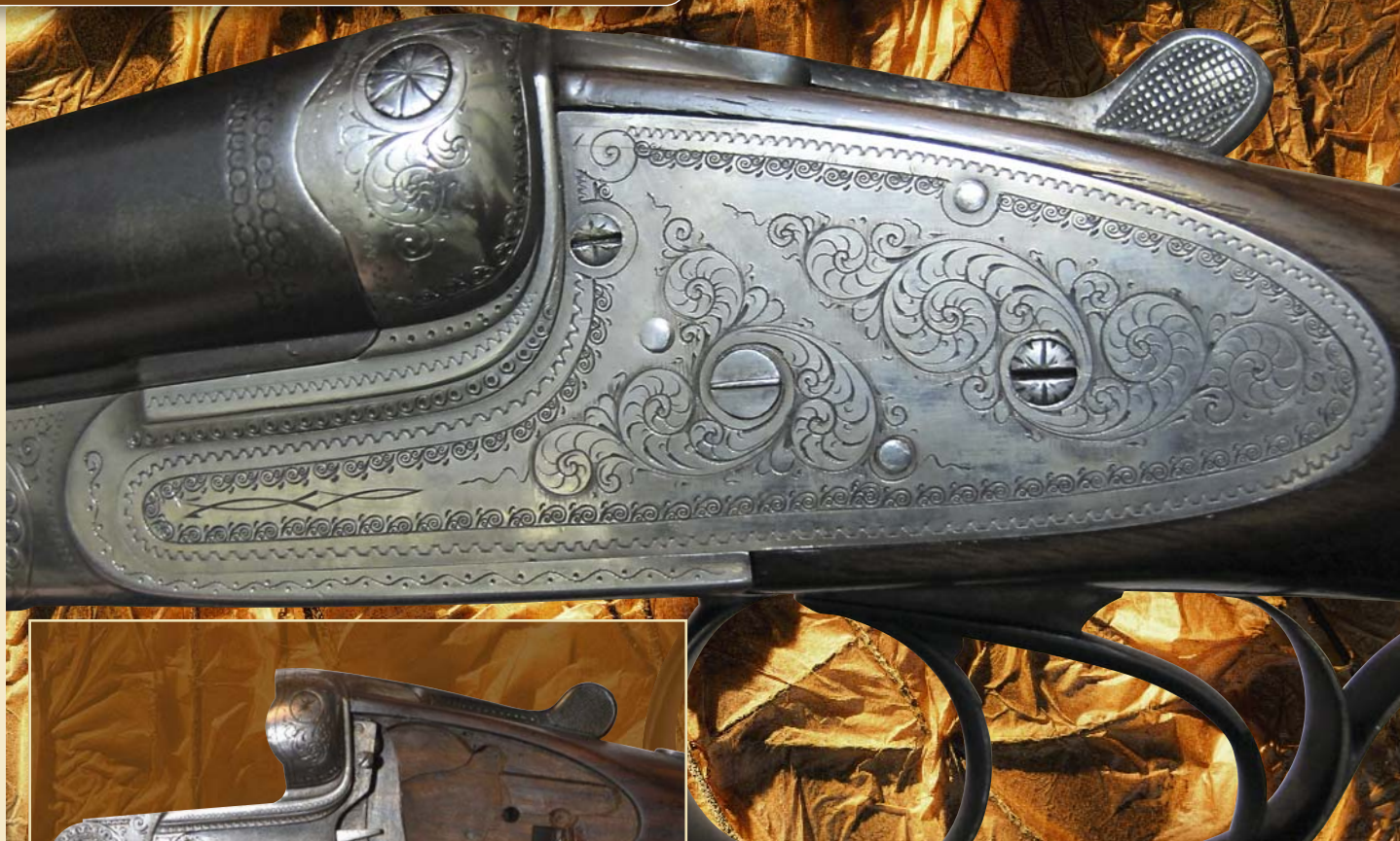
Илл. 12. Ружьё модели 47ST образца 1949 г. Выпущена большая партия двустволок в спортивной и охотничьей версии. Отличительная особенность – три видимых штифта на внешней стороне замочной доски
