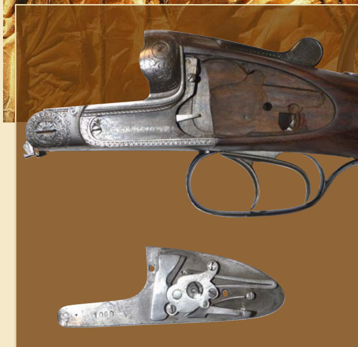
Илл. 11. Унифицированная коробка с обратными замками образца 1948 г., которыми комплектовались спортивные и охотничьи ружья моделей XVI, 47S, 47ST, 29S до начала 1960-х гг.
