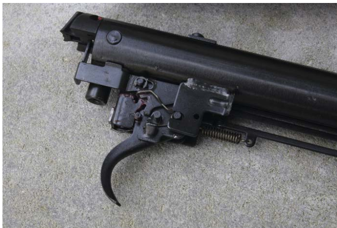
Спусковой механизм пневматической винтовки Webley&Scott Valuemax. Он изготовлен из обычных стальных деталей, приварен к ствольной коробке винтовки и закреплён штифтами. Несмотря на это, ход спускового крючка плавный и не снижает точность стрельбы
