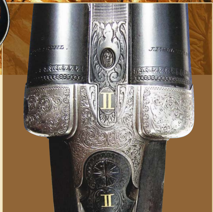
Илл. 3. Ружьё «шестнадцатой» модели из парного комплекта 1933 г. Обратите внимание на форму плечиков коробки, характерную для «старорежимных» изделий
