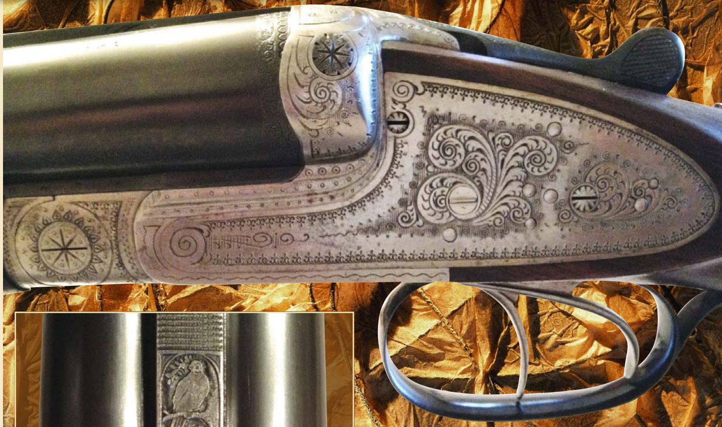
Илл. 13. Спортивная модель 47ST, запущенная в производство в 1954 г. на предприятии VEB Ernst Thälmann Werke, Kombinat Suhl. Ружьё имеет обратные замки с пластинчатыми боевыми пружинами, аналогичные ударным механизмам моделей 47S и XVI. С этого же года большую часть ружей собирали из унифицированных комплектующих Комбината, другая часть изделий поступала на рынок с VEB FORTUNA (фото И. Воробьёва)
