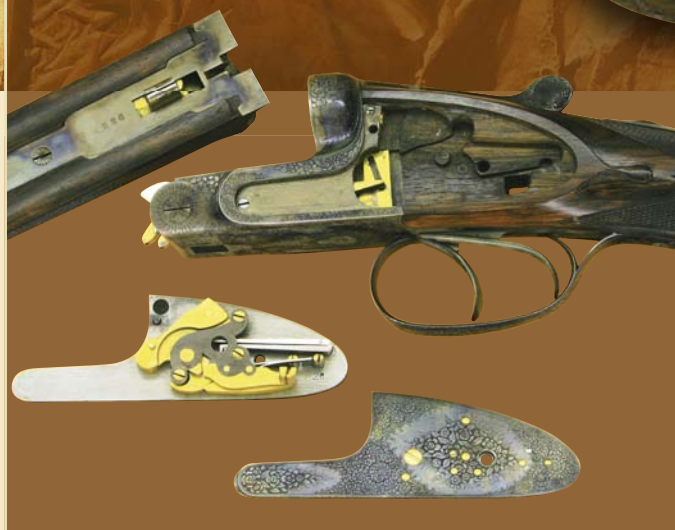
Илл. 6. Конструкция взводящего и ударного механизмов ружья Модели ХVІР
