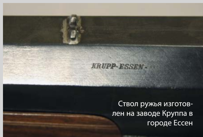
Два отверстия в казен- ной части ствола – заслуга наших разре- шителей
